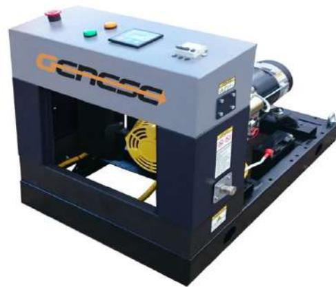
Серия **Standard** производится на базе V-образного 2-х цилиндрового двигателя **Loncin LC2V78FD-1**, объемом **678cc** и мощностью **21 л.с.** Данный двигатель имеет хорошие выходные характеристики, что обеспечивает легкий старт и ровность работы установки на максимальных нагрузках.
